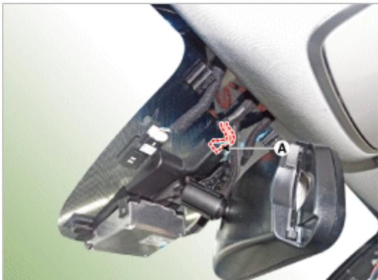
4. 拧下固定螺钉，向上推ECM后视镜基座，拆卸ECM后视镜总成(A)。
